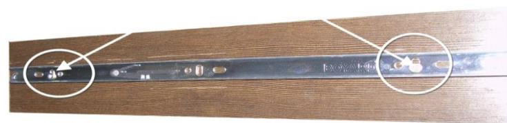
3) Оставшуюся часть направляющей крепим с помощью саморезов 3,5x16 .К стойке комода.
